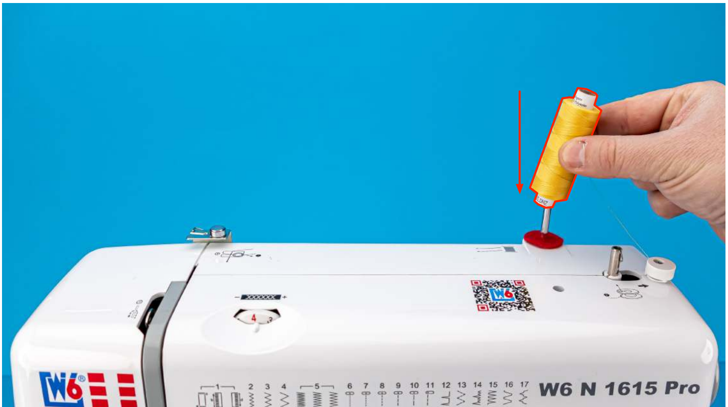
3. Setzen Sie eine W6 Garnrolle auf den Garnrollenstift aus Metall.
