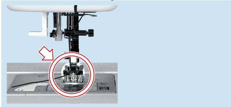
4. Ziehen Sie den Unterfaden, der eine Schlaufe bildet, nach oben, indem Sie den Oberfaden leicht schräg nach oben ziehen.
