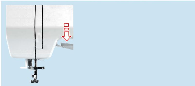
3. Drücken Sie den **«Nadeleinfädler-Hebel»** auf der linken Seite soweit wie möglich nach unten.
