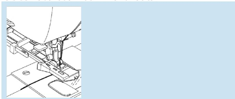
6. Legen Sie den Stoff so unter den Nähfuß, dass die Nadel in die Startposition des Knopfloches einsticht.
